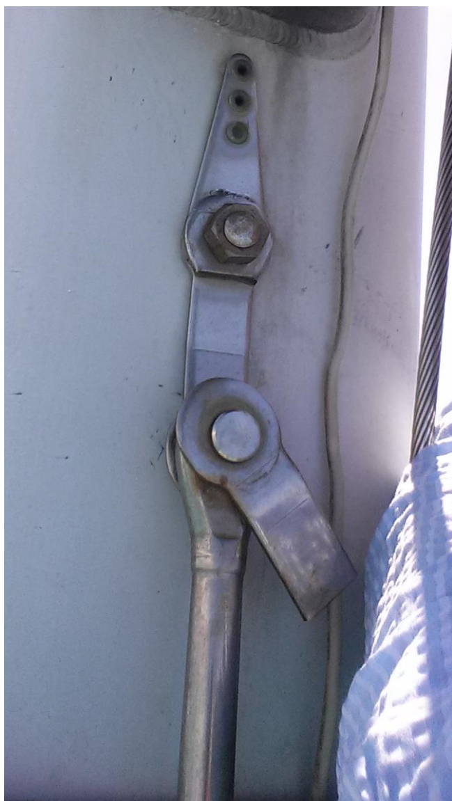
Figura 37 L'attacco rotto della sartia bassa
